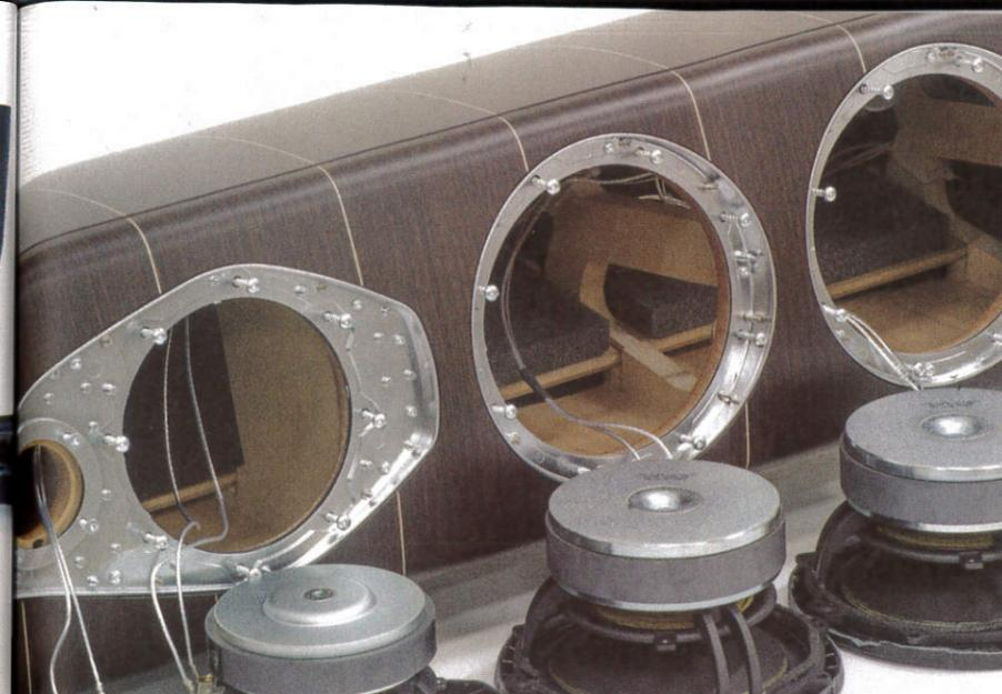
Vista ravvicinata dell'interno del mobile e degli altoparlanti. Notare il foro di decompressione ben svasato dei woofer ed il cestello aerodinamico.
